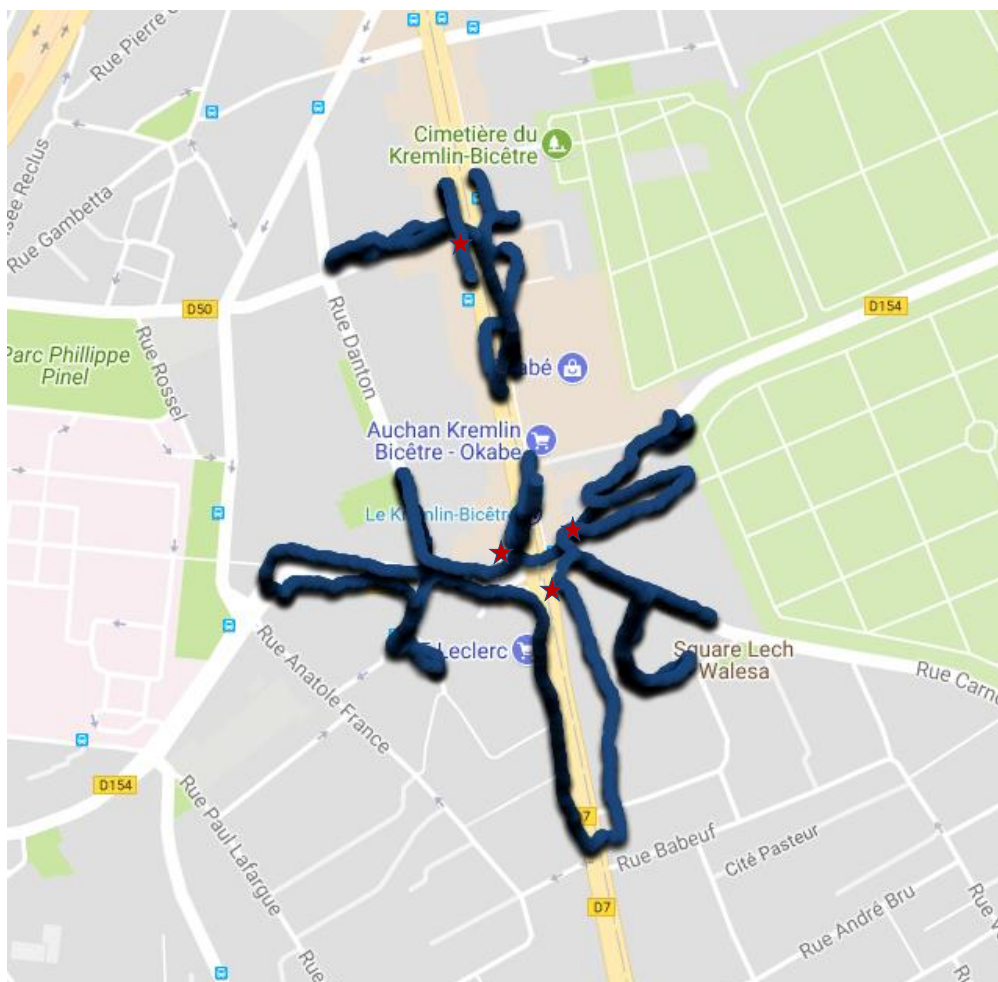
Figure 7 : parcours réalisés autour des sites avec le mobile à trace permettant d'enregistrer différents paramètres radio
